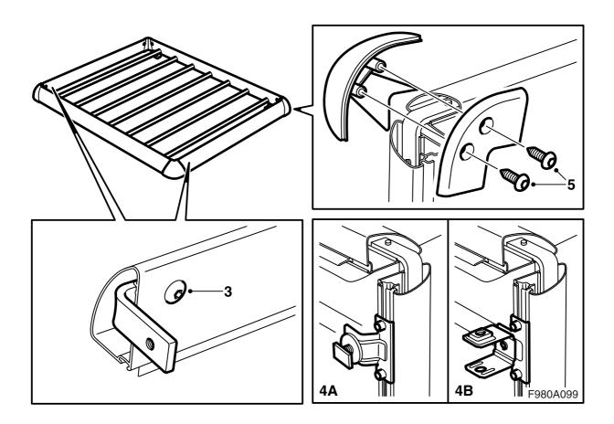
3 用角铁和螺丝将所有的框架安装在一起,首先安装角铁和两个单独的框架(前後框)。
