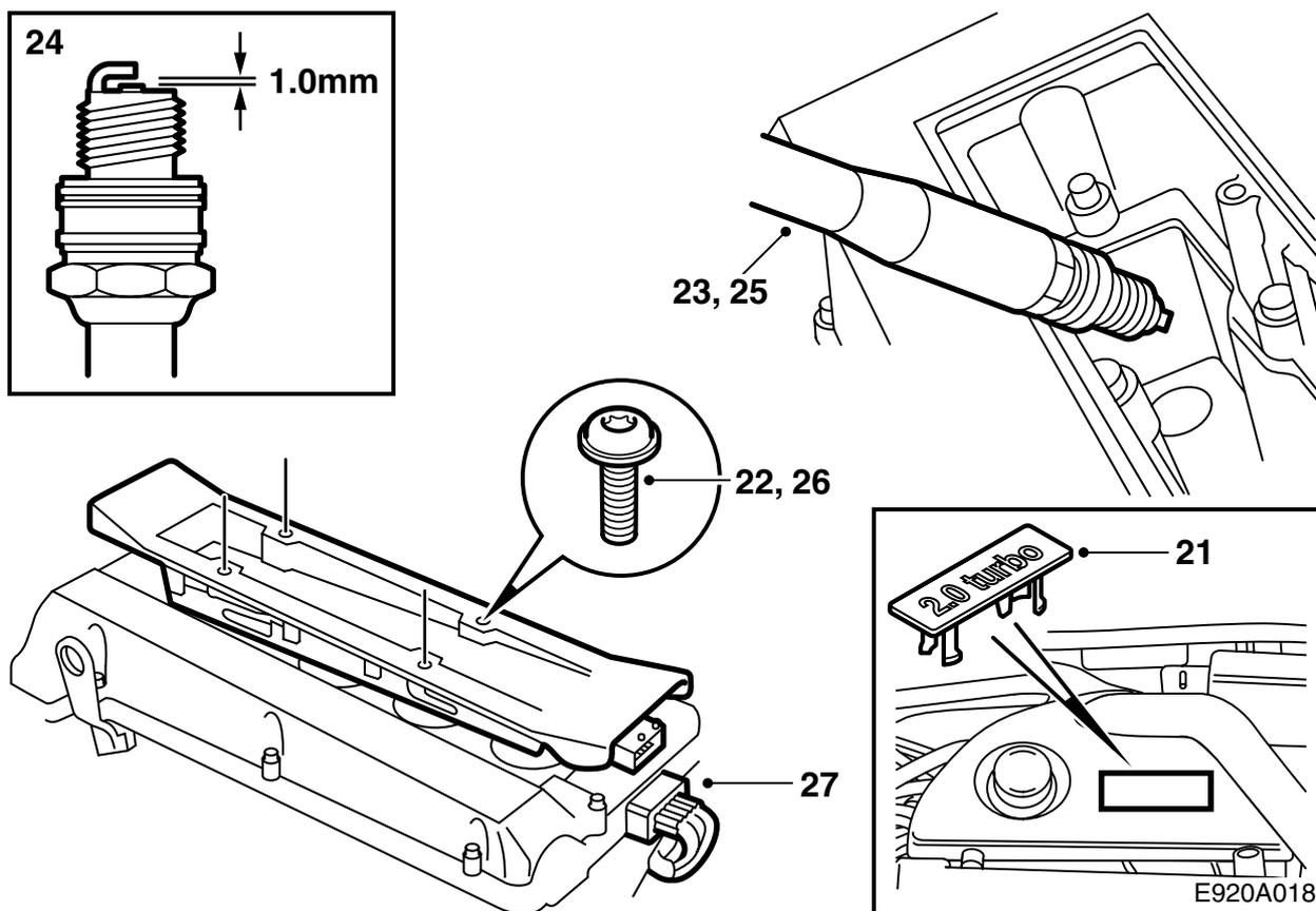
21 拆卸发动机壳罩，拆卸壳罩上面的徽牌，安装新的徽牌。重新装回壳罩。
