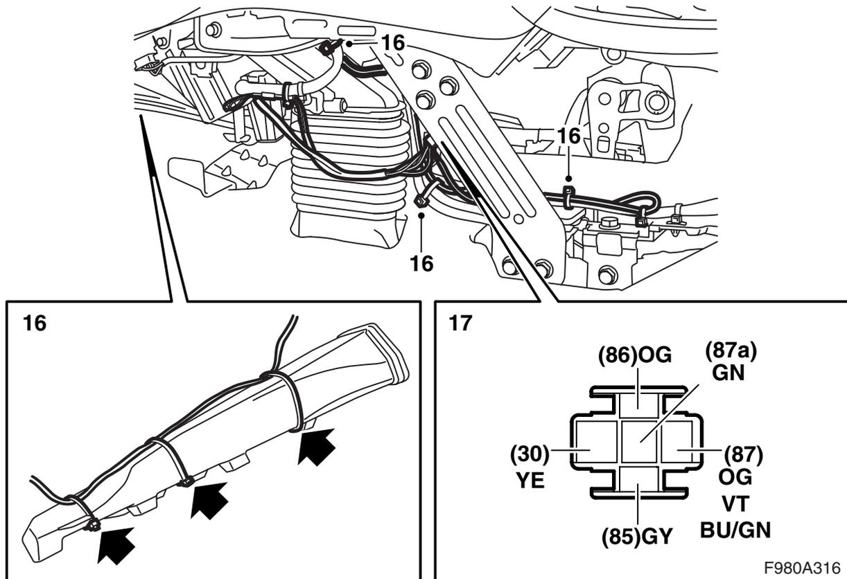
16 將套件的灰色 (GY) 導線沿著風道敷設至儀錶板的左支撐腳。用束箍安裝導線。
