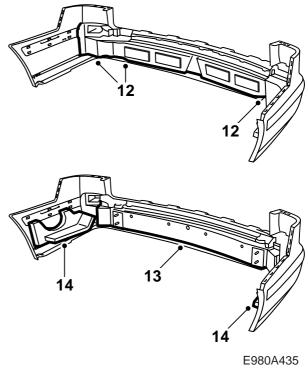
10 **安裝拖車鉤的汽車:**用一把具有鉤狀刀片的通用刀,在保險槓下部按照標出記號的區域,切割出拖車鉤的位置(也可以使用條鋸)。
