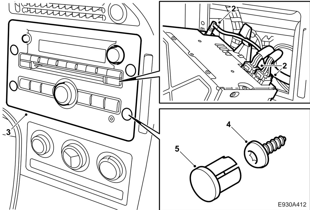
2 Brancher les contacts et la connexion d'antenne à l'unité.
