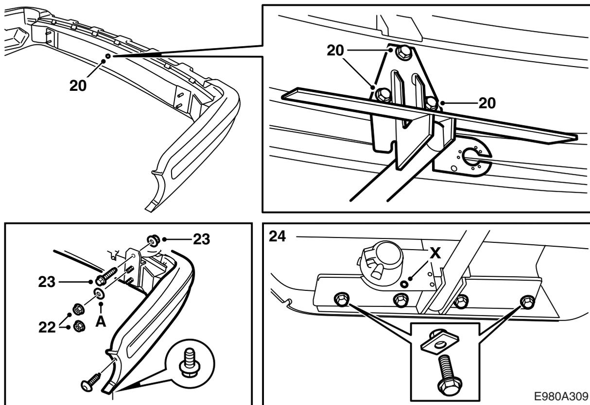
20 Démontez la vis placée dans un des trous de la lame de pare-chocs et assemblez la poignée à boule au pare-chocs. Vérifier que la ligne au dessus de la vis supérieure de la poignée est parallèle à la lame de pare-chocs.
