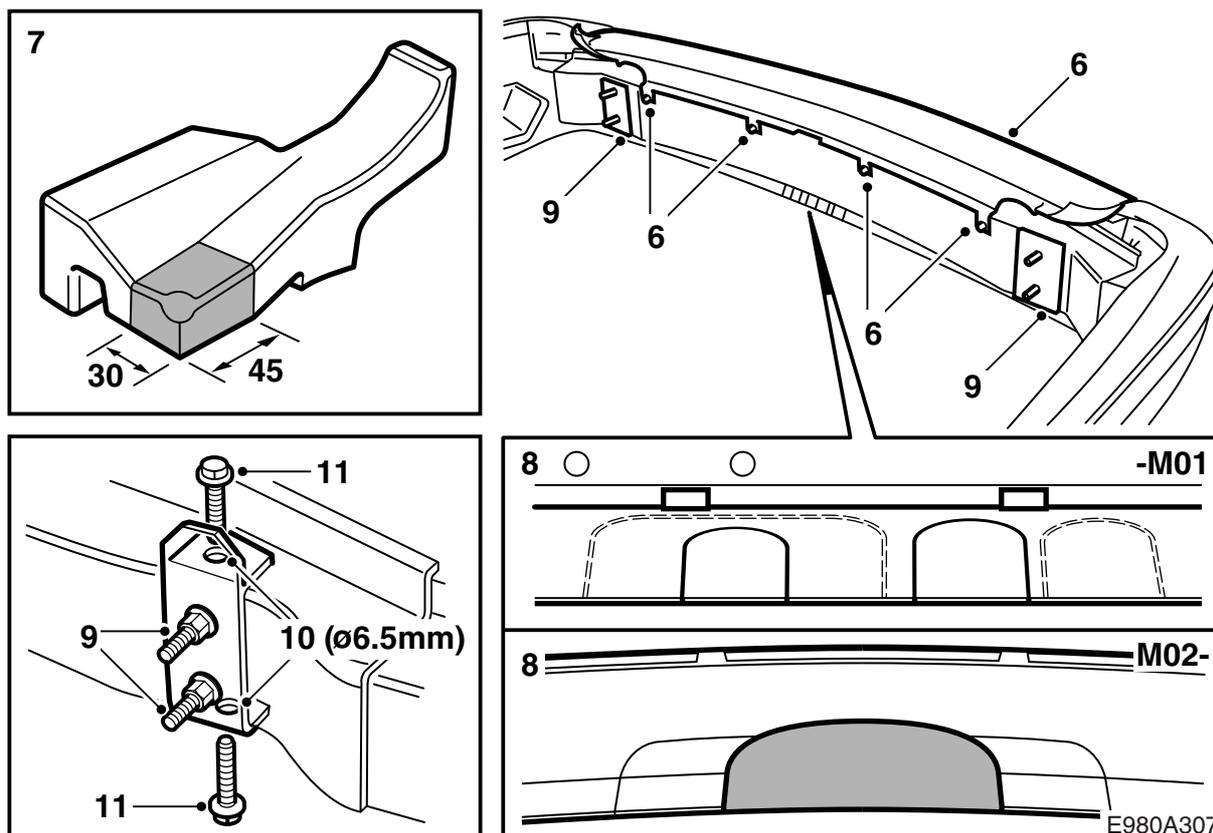
6 **-M01** : Dévisser en partie les vis de la partie supérieure de l'enveloppe de pare-chocs et tirer cette dernière avec précaution hors de ses fixations.
