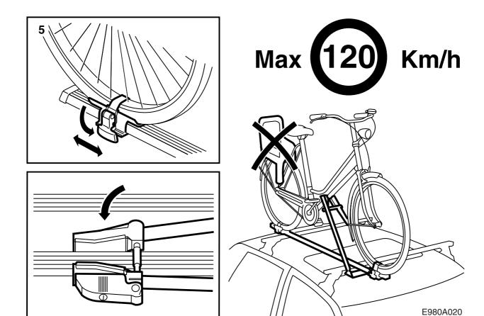
5 Das Rad des Fahrrads an den Radplatten festspannen. Den Riemen über die Felge ziehen und in der Aussparung auf der Unterseite befestigen.
