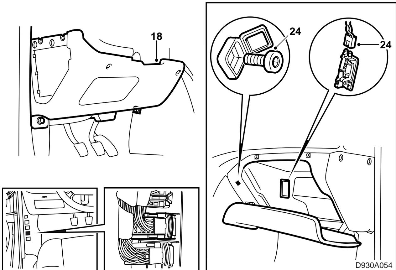
18 Das Armaturenbrettunterteil auf der Fahrerseite entfernen.
