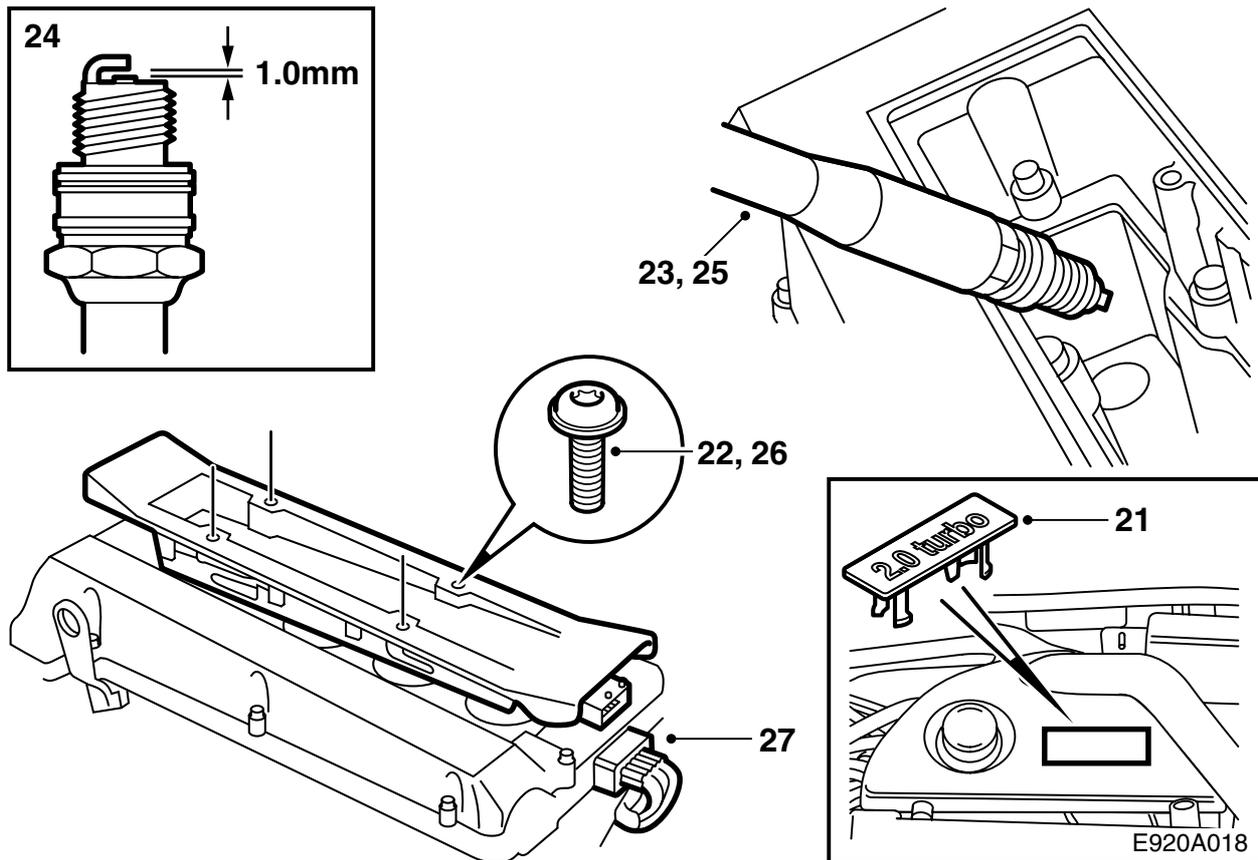
21 Die Abdeckung des Motors ausbauen, das Emblem von der Abdeckung entfernen und das neue Emblem montieren. Die Abdeckung wieder anbringen.
