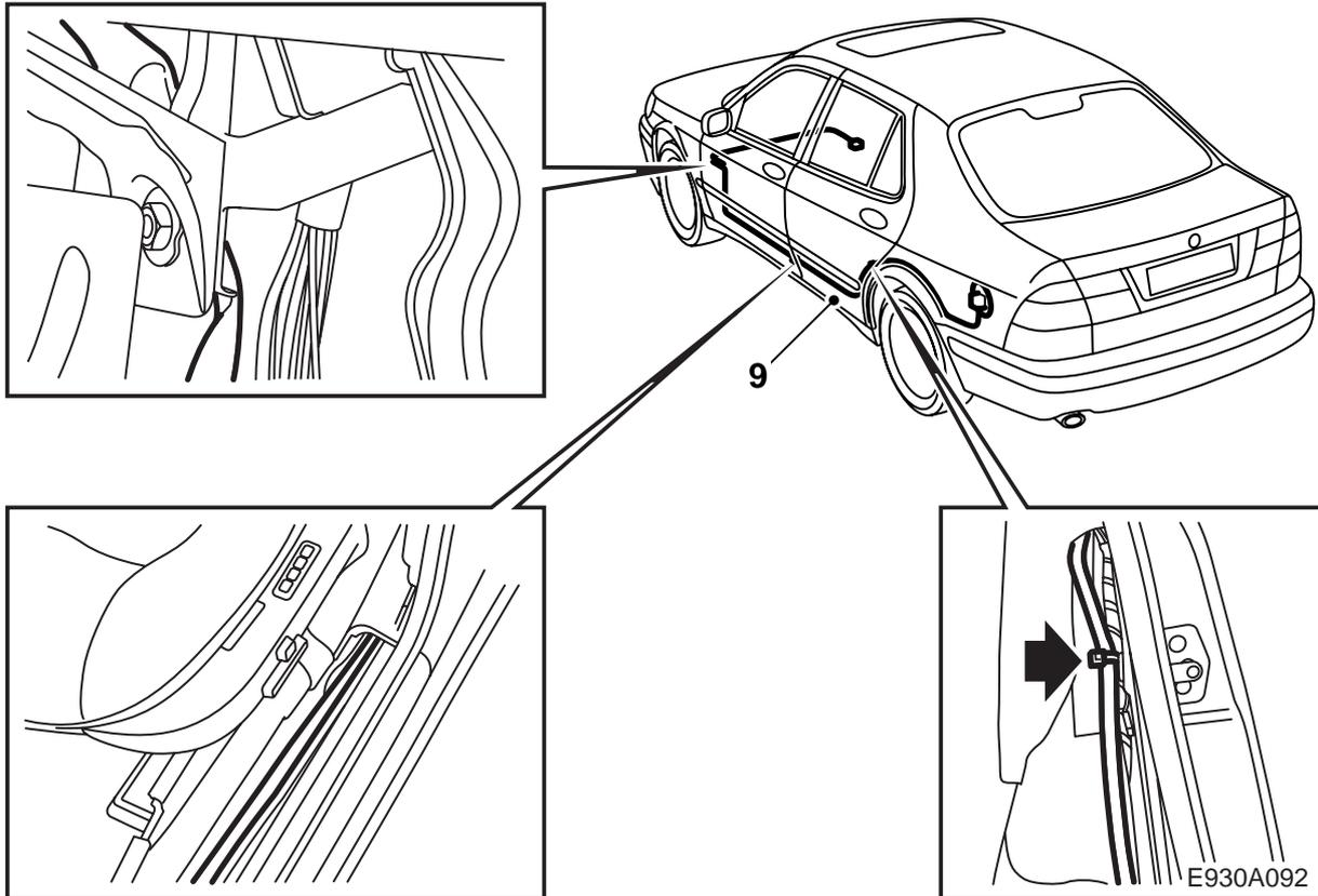
9 Das Leitungsnetz entlang dem Fahrzeugleitungsnetz (bei den Schwellern in den Leitungsnetzkanal ziehen) verlegen. Das Leitungsnetz unter den Schaumstoffblock und Luftkanal an der linken B-Säule führen.
