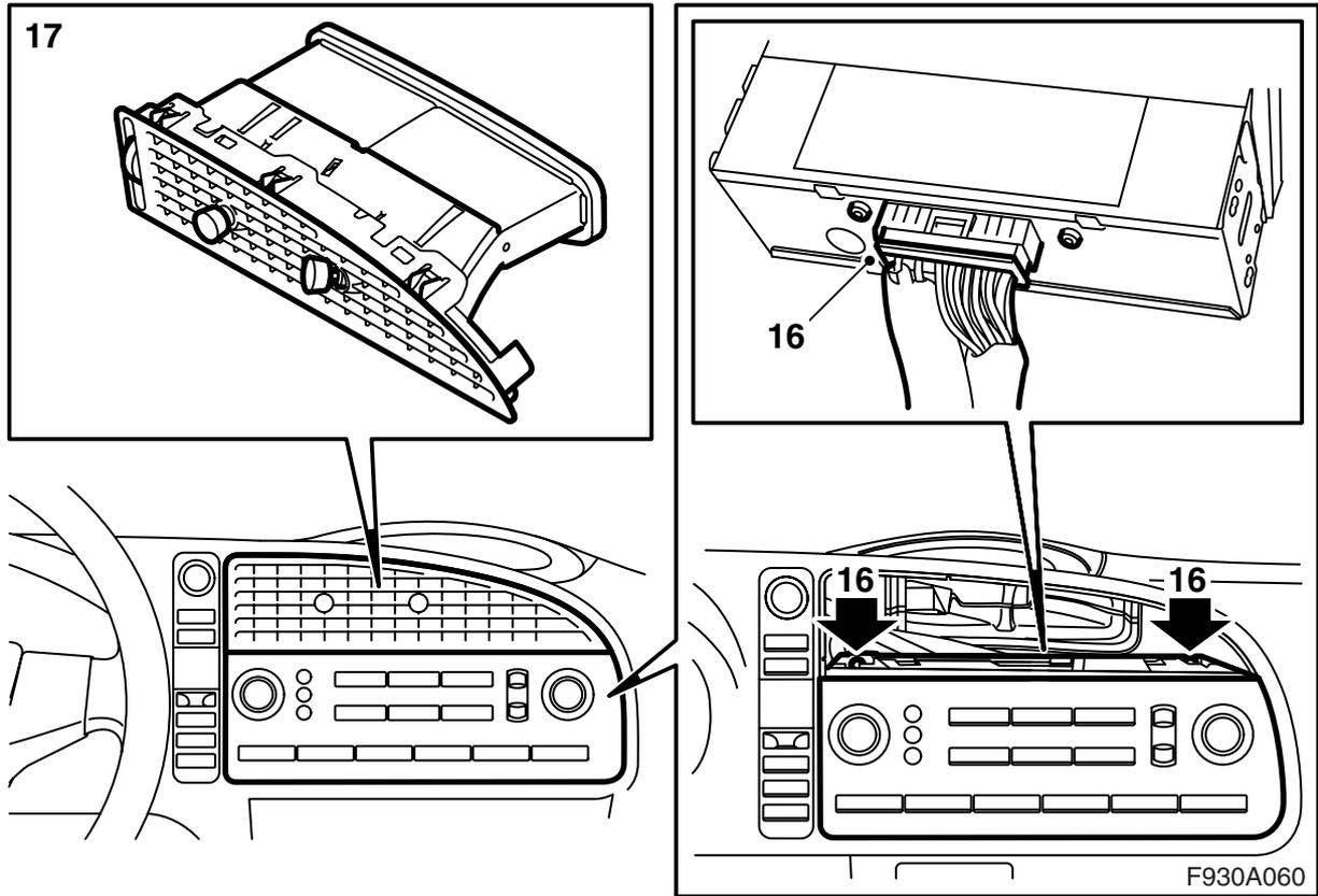
16 Collegare il connettore al pannello di comando ed installarlo.
