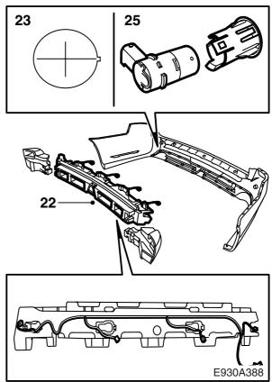
26 Sistemare il cablaggio nella sezione centrale in schiuma. Collegare il cablaggio ai sensori e rimontare le parti in schiuma e la traversa.
