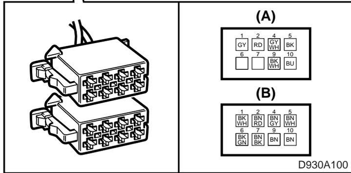
ISO 規格に適合した接続コネクタ (A)、電流供給、etc.
