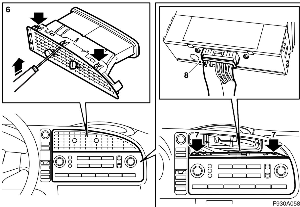
6 Демонтируйте средний выпускной канал на панели, пригнув осторожно три верхних захвата, доступ к которым открывается через решетку. Потяните одновременно направляющий стержень прямо наружу.
