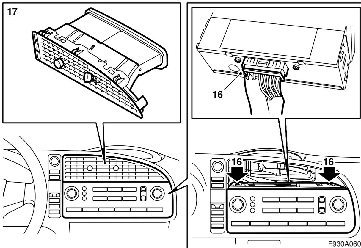
16 Подсоедините контактный разъем к панели управления и смонтируйте его.
