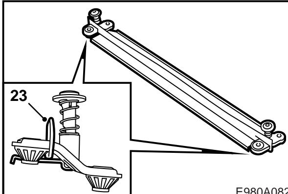
23 Вдавите два нагруженных пружинами держателя радиатора и охладителя нагнетаемого воздуха и переместите их назад к двигателю. Снимите держатели.
