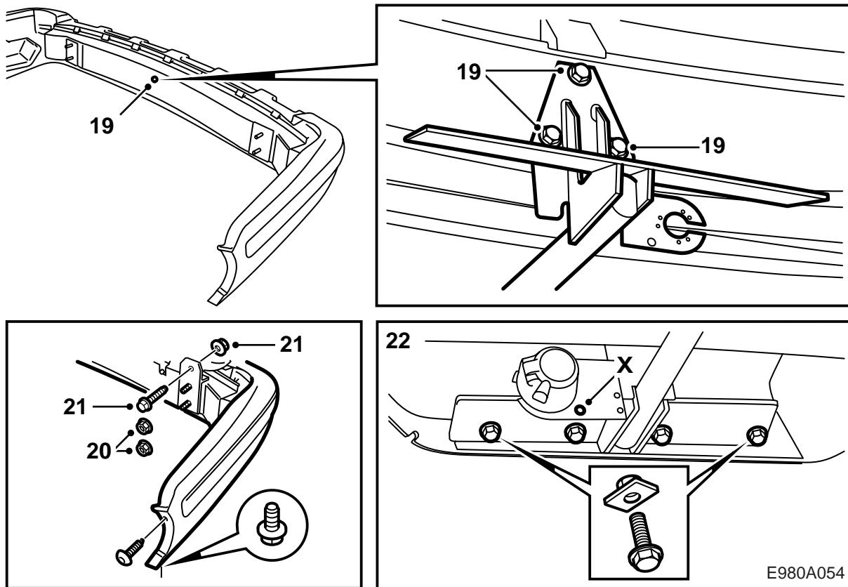
Х Петля для закрепления цепи безопасности прицепа/жилого прицепа.
