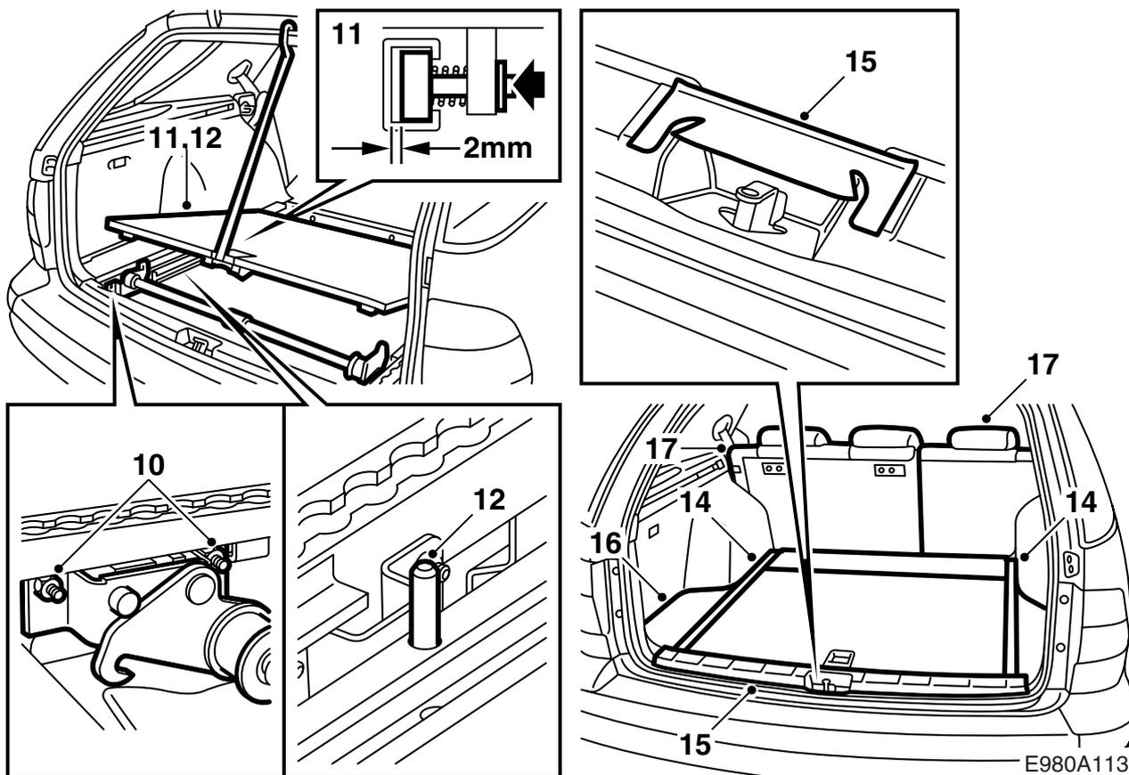
10 Смонтируйте фиксирующие крючки и ролики на шинах для крепления груза, как показано на рисунке. Пользуйтесь двумя винтами и стопорными гайками. Накапайте немного масла между роликами и крючками и вытрите избыточное масло.
