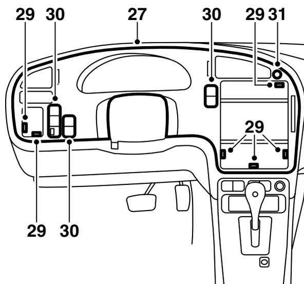
27 Демонтируйте держатель для чашек с задней стороны старой приборной панели (2 винта) и смонтируйте его на задней стороне новой. Установите приборную панель на место.
