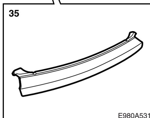
35 **5D -M01:** Montar la parte superior de la funda del parachoques encajándola primero en los cuatro tornillos del parachoques. Fijar a continuación la parte superior de la funda con los ganchos alrededor del borde. Apretar los tornillos.
