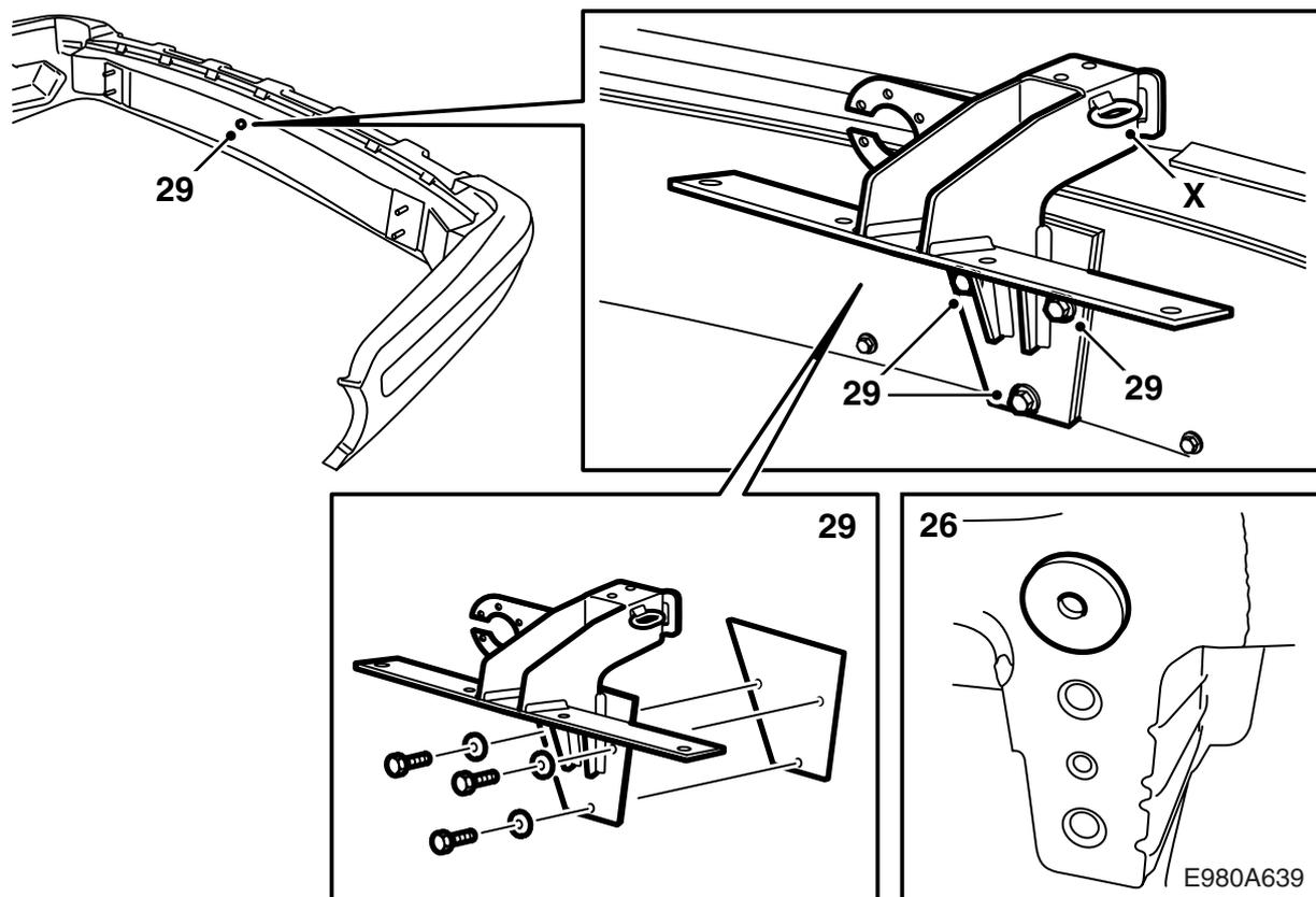
26 Montar las juntas en la carrocería (adhesivas) y aplicar el sellador de cavidades Terotex HV 400 en superficies interiores. Montar los manguitos.
