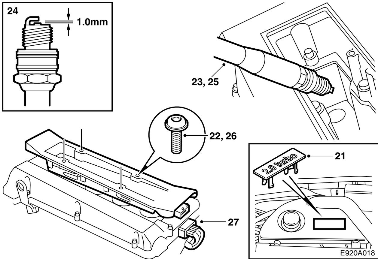
21 Desmontar la cubierta de recubrimiento del motor, desmontar el emblema de la cubierta y montar el nuevo emblema. Montar la cubierta de recubrimiento.
