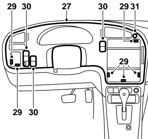
27 Desmontar el portavasos de la parte trasera de la placa de instrumentos original (2 tornillos) y montarlo en la parte trasera de la placa de instrumentos nueva. Colocar la placa de instrumentos en su sitio.
