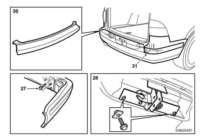
27 Skruva fast förstärkningarna till bilen.
