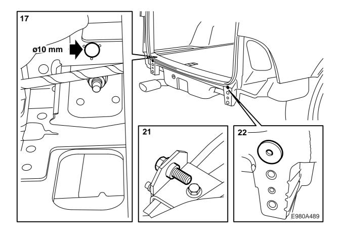
17 Använd skyddsglasögon och borra, med ett 10 mm borr, genom hylsorna, hålen i akterspegeln och förstärkningarna.
