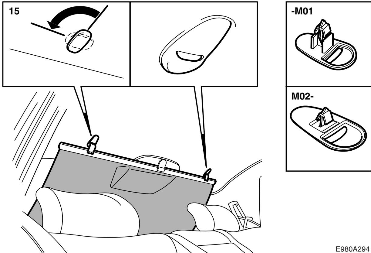
15 拆卸固定車頂後緣的卡扣，方法是將其旋轉 90 度。
