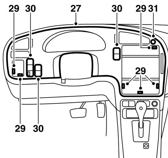
27 從原來儀錶板的背面拆卸置杯架 (2 個螺絲)，並且將其安裝至新的儀錶板背面。將新的儀錶板提入到位。
