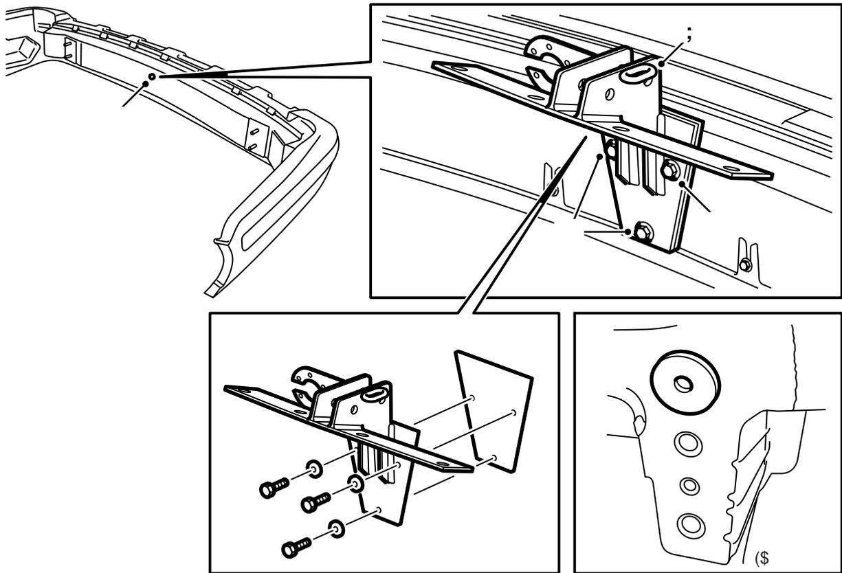
24 安裝密封件至車身 (自貼式), 並且在內壁塗抹孔壁密封劑 Terotex HV 400。安裝套筒。
