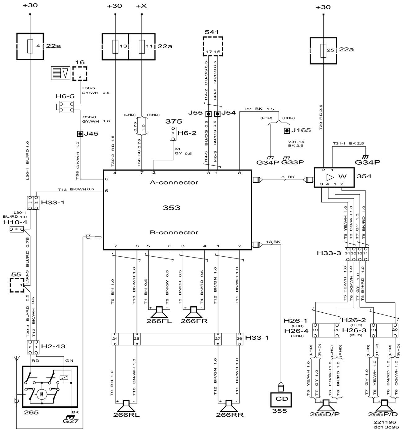
Schéma électrique Saab 900 M97
