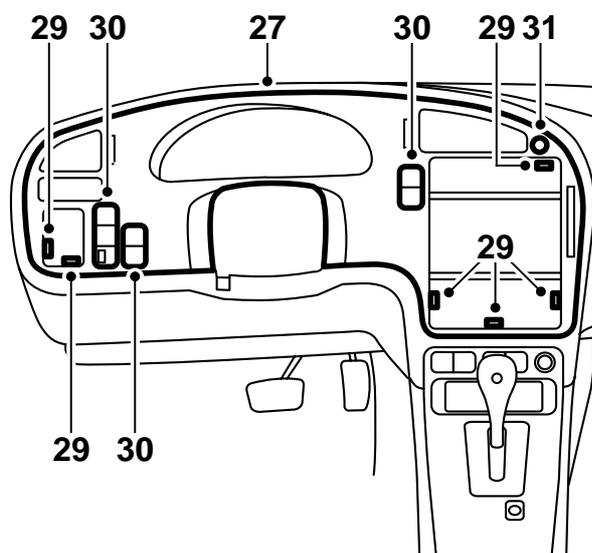
27 Déposer le porte-gobelet par l'arrière du tableau de bord d'origine (2 vis) et le poser sur la face arrière du nouveau. Poser le tableau.
