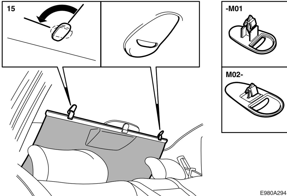
15 Déposer les clips qui maintiennent le toit au bord arrière en les tournant de 90 degrés.
