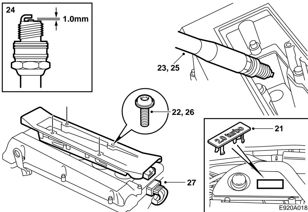
21 Déposer le couvercle d'étanchéité du moteur, déposer l'emblème du couvercle et poser le nouvel emblème. Reposer le couvercle.
