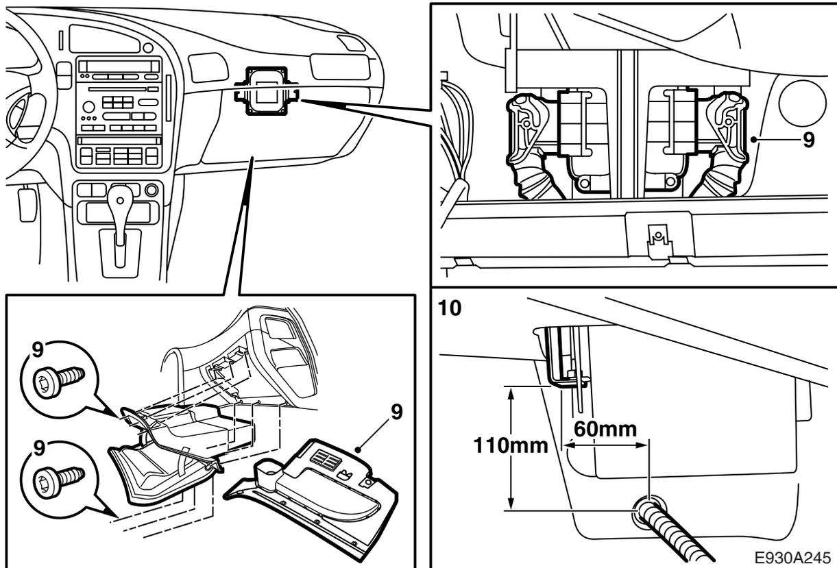
9 Handschuhfach ausbauen, und die Matte an der Oberkante umlegen. Falls Handschuhfachkühlung vorhanden, den Kühlschlauch entfernen.
