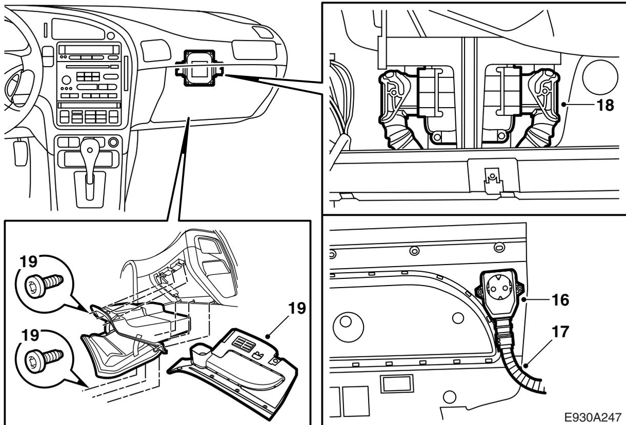
14 Das 2,0 m lange Anschlußkabel durch die Spritzwanddurchführung bis zu der Stelle ziehen, wo der Innenraumanschluß angebracht werden soll. Das Kabel mit Spannband befestigen.
