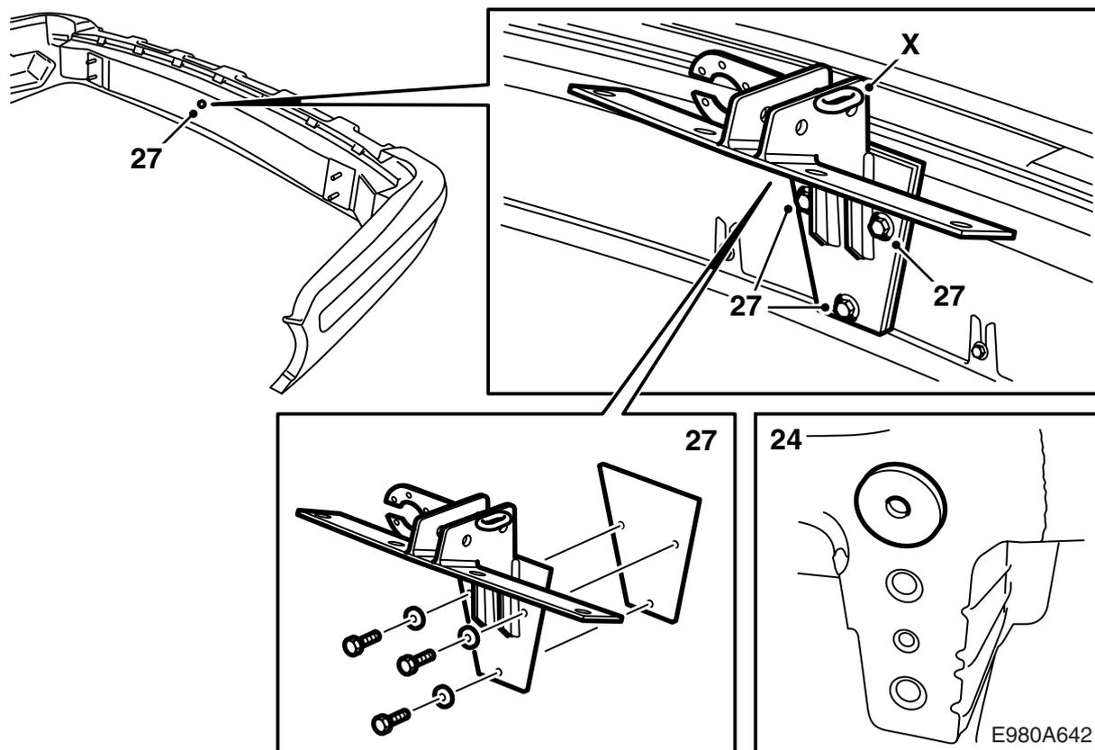
24 シーリングをボディに取り付け (のり付き)、穴用シール剤 Terotex HV 400 を内側の面に塗布する。スリーブを取り付ける。
