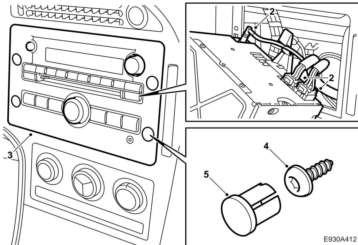
2 Conectar el conector y la conexión de antena a la unidad.
