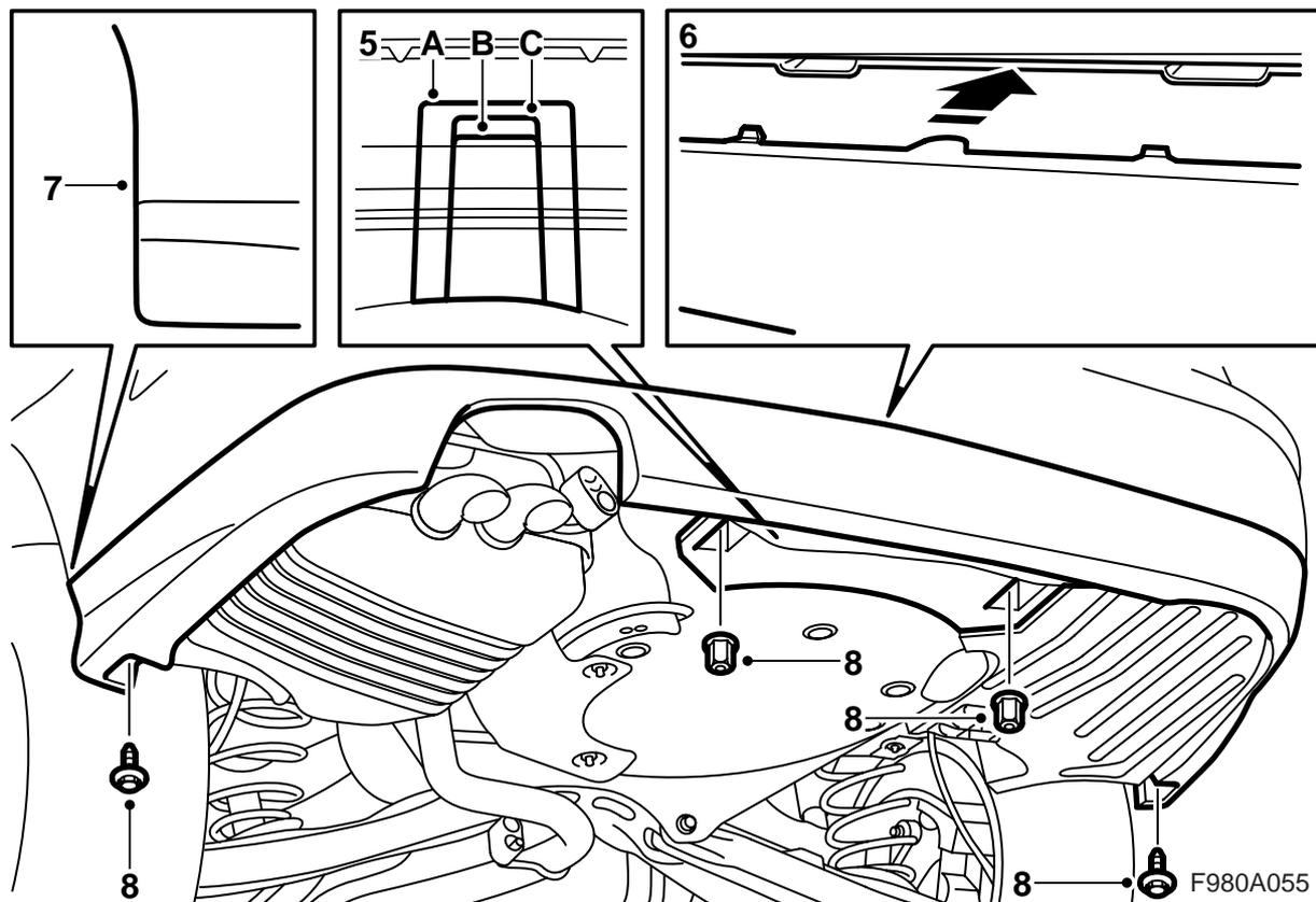
5 Bil utrustad med dragkrok: Skär ut, genom att använda en universalkniv med krokformat blad, i stötfångarhöljet för dragkroken (även sticksåg kan användas).
