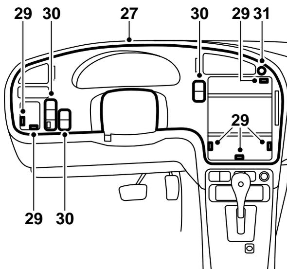
27 Demontera kopphållaren från baksidan av den ursprungliga instrumentplattan (2 skruvar) och montera den på baksidan av den nya. Lyft instrumentplattan på plats.
